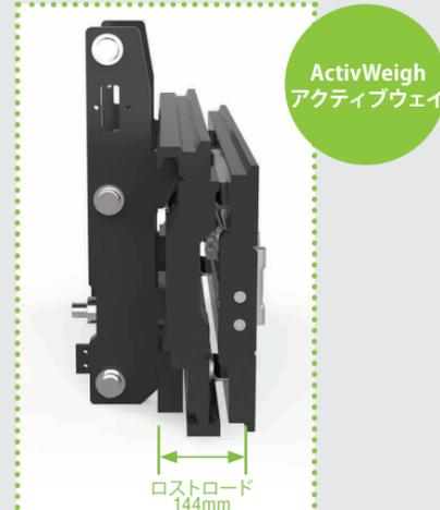
アクティブウェイは、サイドシフトとフォークポジショニング機能を備えた一体型重量計でロストロードの低減と、フォークリフトの許容荷重の最大化を実現します
